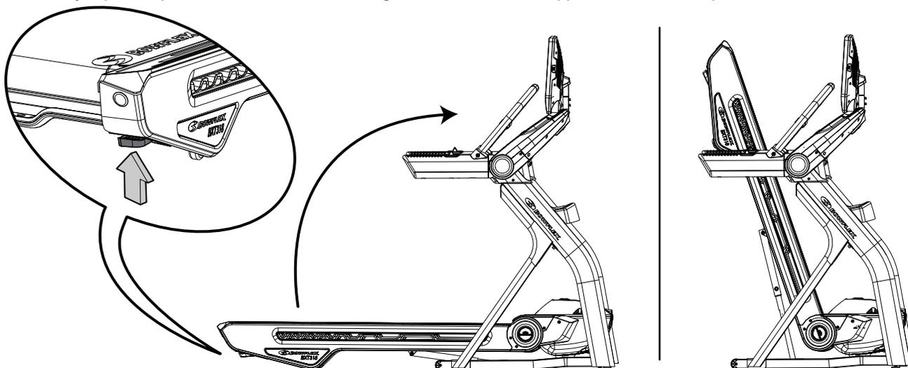
**!** N'utilisez pas la courroie de marche ou le rouleau arrière pour soulever le tapis roulant. Ces pièces ne se verrouillent pas en place et peuvent bouger brusquement. Vous pourriez vous blesser ou endommager l'appareil.
