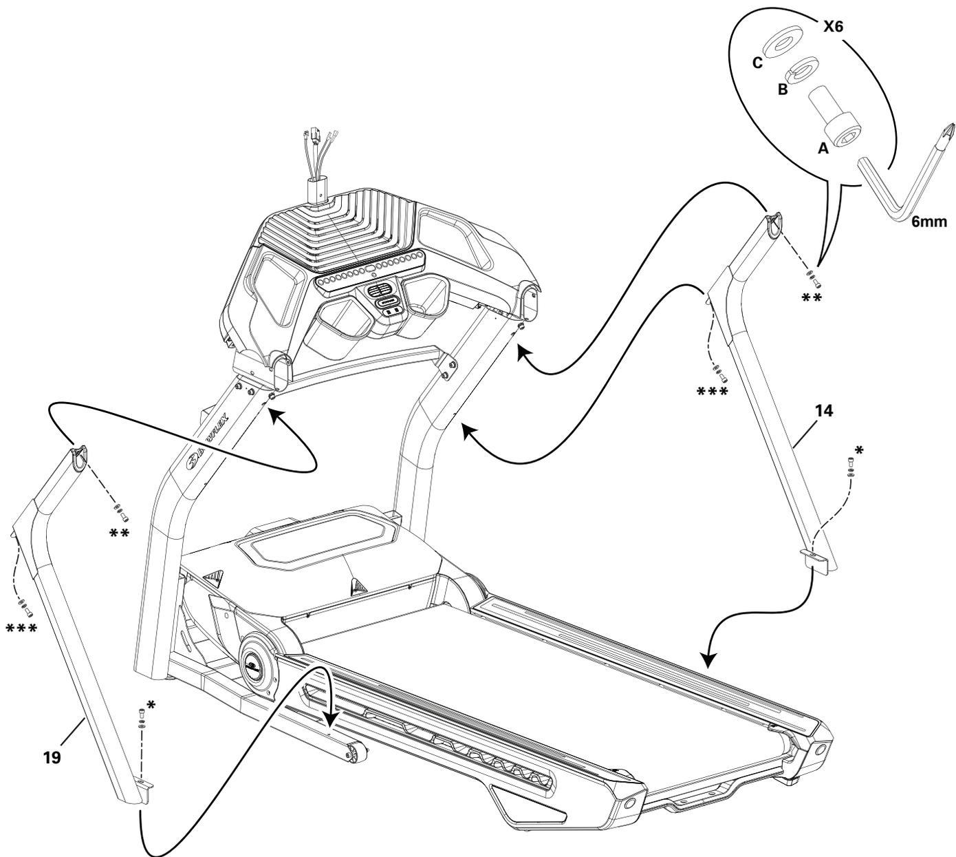
5. Faites passer les câbles dans le mât de console, puis fixez ce dernier à l'armature de la console.
