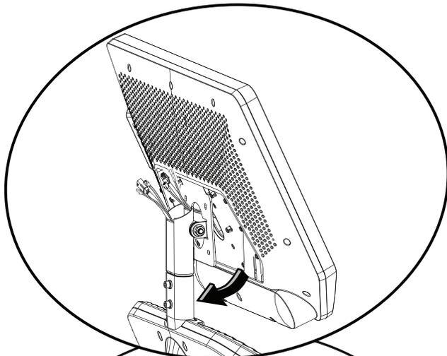
a. Placez la console sur son mât et faites passer les câbles à travers ce dernier.
