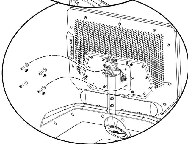
b. Faites complètement pivoter l'assemblage de la console vers le bas et fixez-la au mât de console.
